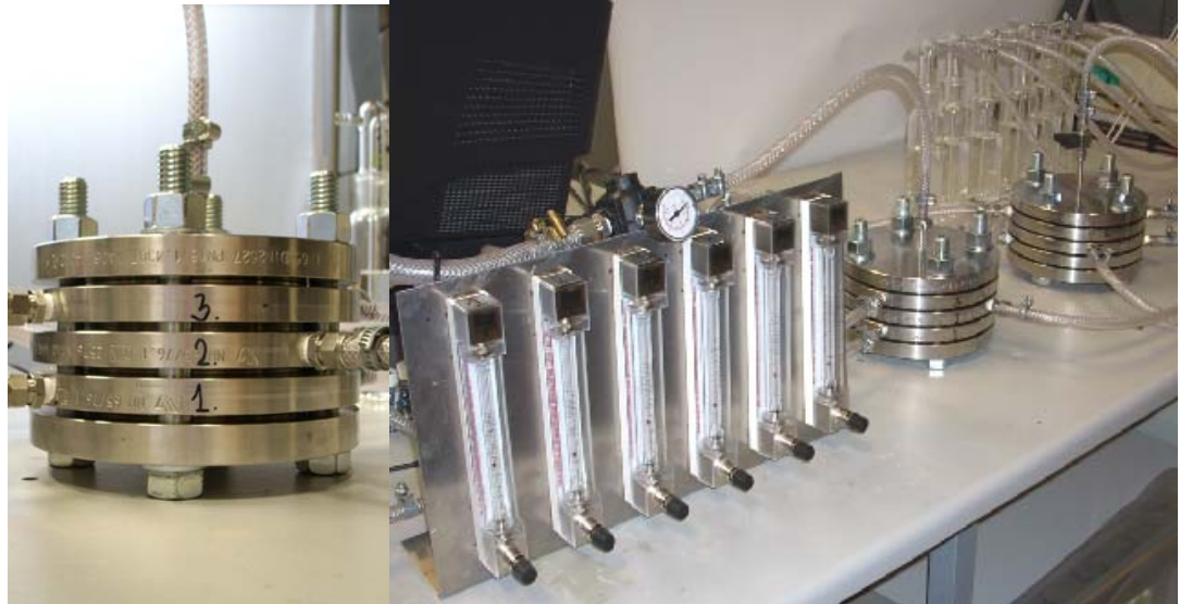
Figuur 6.9: Links: de flenzen. Rechts: rotameters, flenzen en borrelflesjes.
