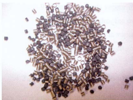
Figuur 7: Mengsel van katalysatordeeltjes en roestvrij stalen veertjes
