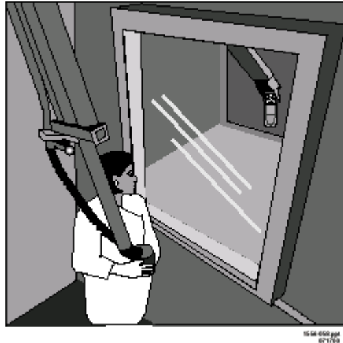
Figuur 2.6 Hotcel met manipulator
