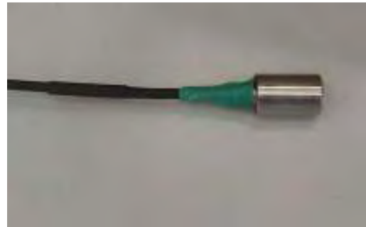
Figure 11 : Pièce usinée en acier pour les mesures avec le cristal OSL
