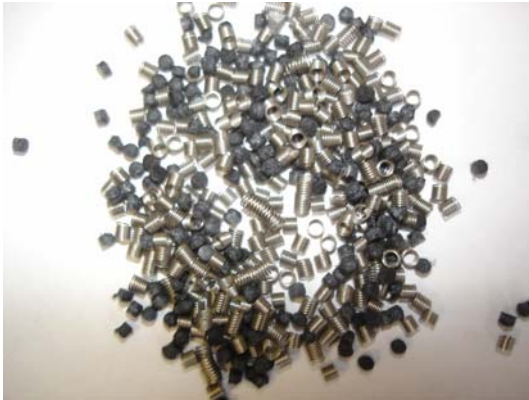
Figure 4.3 : Mélange de particules de catalyseur et de spirales en acier inoxydable
